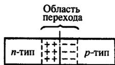
Сопrotивление запирающего слоя можно изменить с помощью **внешнего** электрического поля. Если направление внешнего поля  $\vec{E}$  совпадает с направлением  $\vec{E}_k$  поля контактного слоя (а), то запирающий слой расширяется
