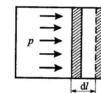
Если находящийся под поршнем в цилиндрическом сосуде, газ, расширяясь, передвигает поршень на расстояние  $dL$ , то производит над ним **работу**  $\delta A = FdL = pSdL = pdV$ , где  $S$  – площадь поршня.
