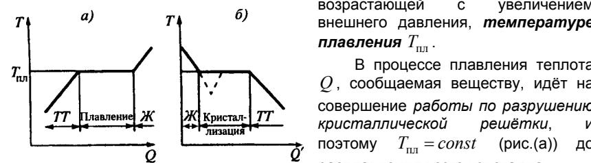
В процессе плавления теплота  $Q$ , сообщаемая веществу, идёт на совершение работы по разрушению кристаллической решётки, и поэтому  $T_{пл} = \text{const}$  (рис.(а)) до расплавления всего кристалла.
