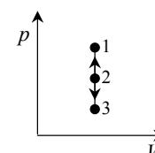
Диаграмма этого процесса – **изохора** – в координатах ( $p, V$ ) изображается прямой, параллельной оси ординат (ось  $p$ ). Процесс 2–1 – изохорный нагрев, процесс 2–3 – изохорное охлаждение.
