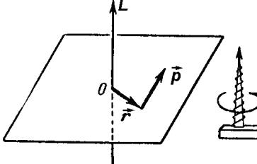
**Моментом импульса относительно неподвижной оси  $z$**  называется скалярная величина  $L_z$ , равная проекции на эту ось вектора момента импульса, определённого относительно произвольной точки  $O$  данной оси. Значение момента импульса  $L_z$  не зависит от положения точки  $O$  на оси  $z$ .
